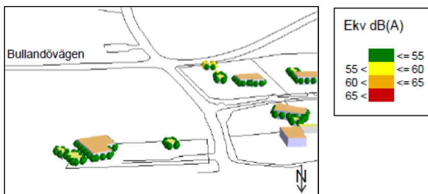
Figur 18. Ekvivalenta ljudnivåer vid fasad sett från norr vid full omvandling till permanentbostäder.
