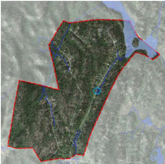
Figur 11 Områden som riskerar att översvämmas vid ett vattenstånd på ca 3 meter över havet. Området med risk för instängt vatten är markerat med blå ellips.
