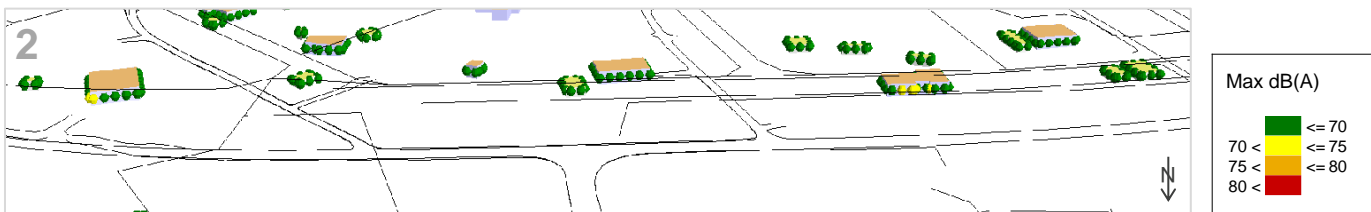
Figur 6.10 Maximala ljudnivåer vid fasad sett från norr (idag).
