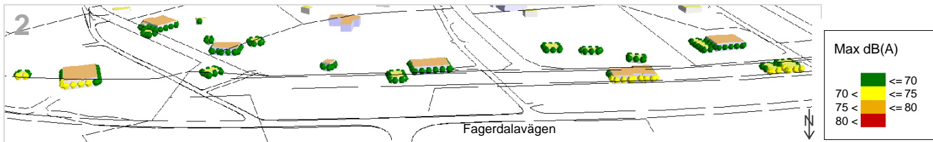
Figur 6.13 Maximala ljudnivåer vid fasad sett från norr (vid full omvandling till permanentbostäder).
