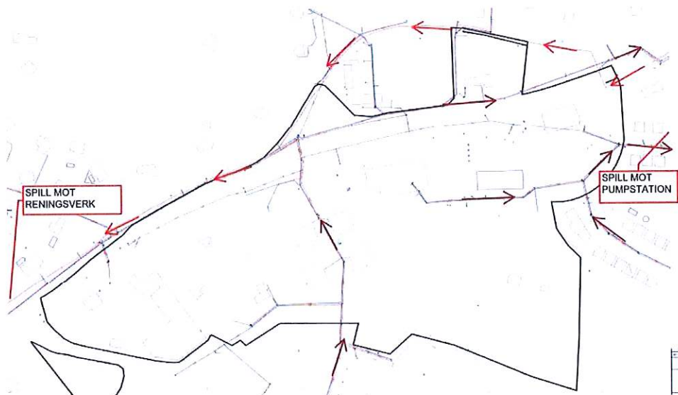
Figur 1. Översikt befintligt VA-nät i Hemmesta centrum (svart linje plangräns). Mörkröda pilar visar riktningen för spill med självfall mot pumpstation. Ljusröda pilar visar riktning för trycksatt spill mot reningsverk. Vatten och självfallspill följs för det mesta åt.
