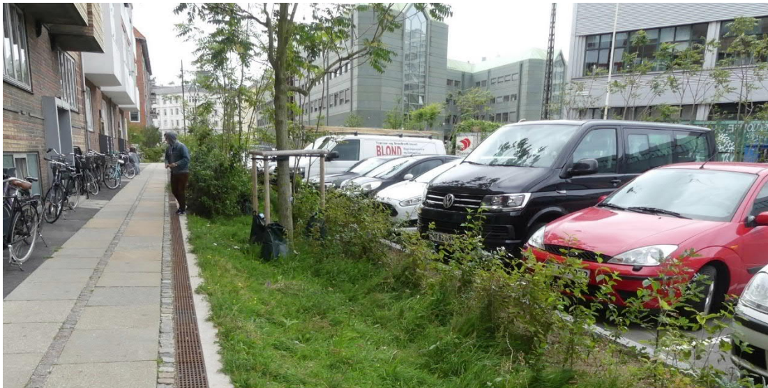
Figur 22 Nedsänkt biofilter i anslutning till parkeringsyta och gångstråk.
