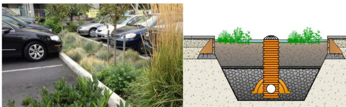
Figur 19 Biofilter i form av nedsänkt vegetationsytan med underliggande makadam.
