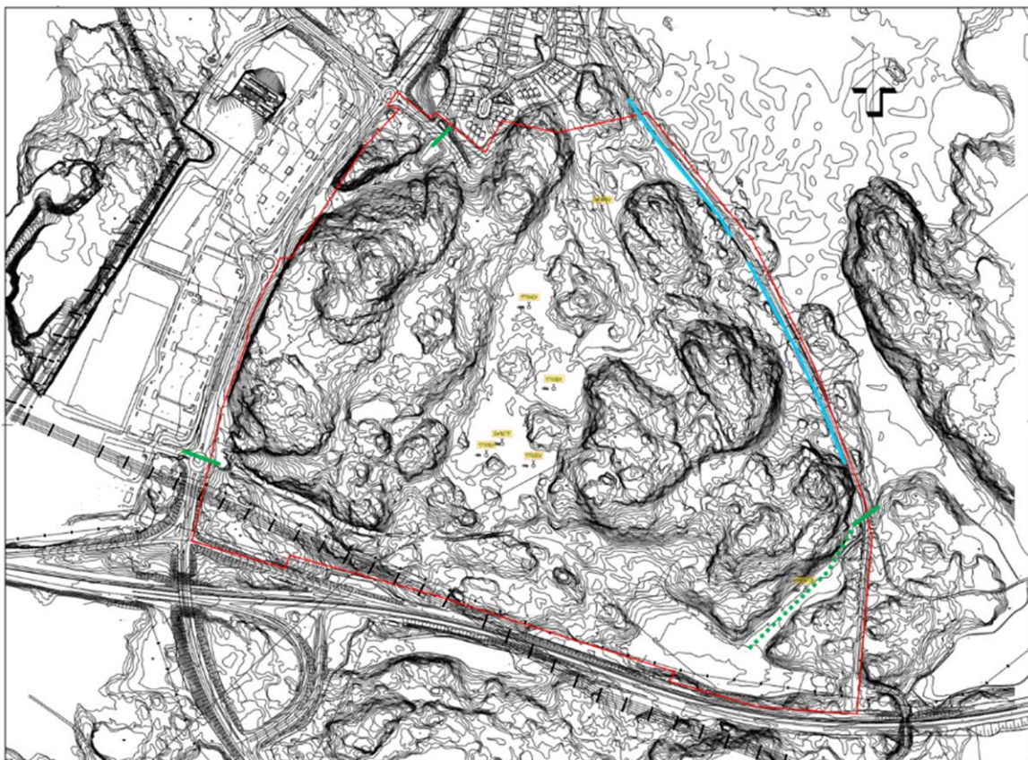
Figur 9 Befintliga trummor inom området -gröna linjer, öppet dike - blå linje, täckdike - grön punktstreckad linje.
