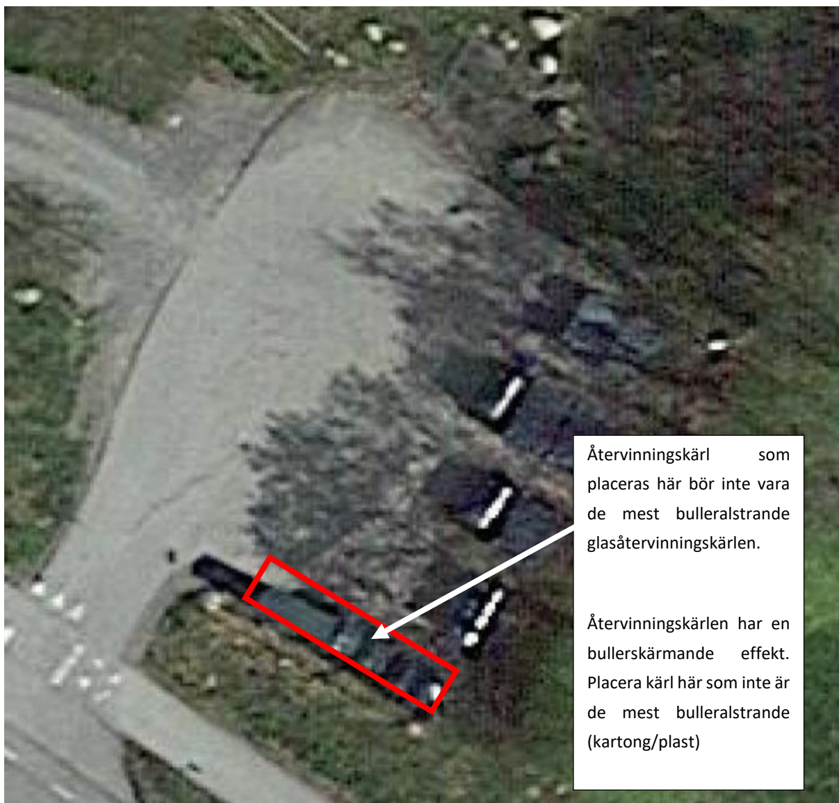
FIGUR 3 ÅTERVINNINGSKÄRLEN KAN PLACERAS SÅ ATT DE MER BULLERALSTRANDE KÄRLEN PLACERAS LÄNGRE BORT FRÅN DE PLANERADE NYA BOSTÄDERNA. ÅTERVINNINGSKÄRLEN HAR ÄVEN EN BULLERSKÄRMANDE EFFEKT SÅ MINDRE BULLERALSTRANDE KÄRL KAN MED FÖRDEL PLACERAS SÅ ATT DE SKÄRMAR BULLER FRÅN GLASÅTERVINNINGSKÄRLEN.
