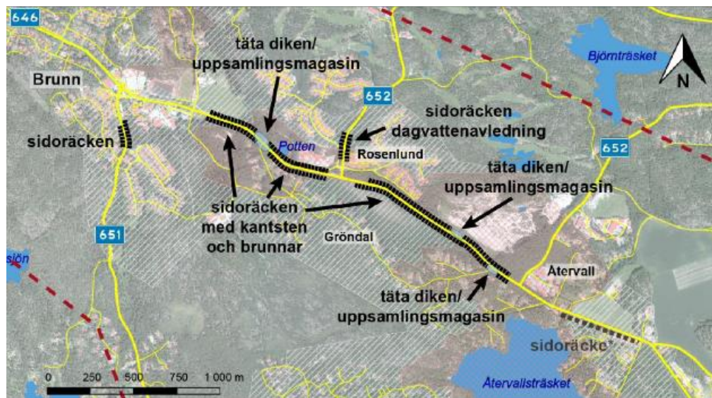
Bild 17: TrV utredning avseende åtgärder för ökat skydd av grundvattentäkt.
