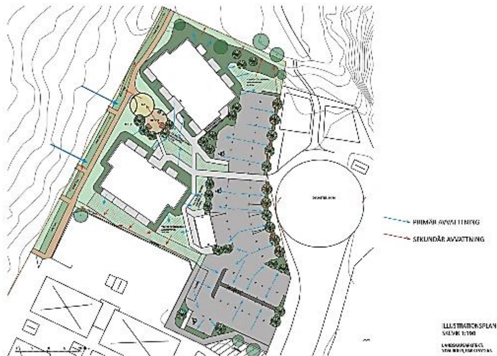
Figur 11 Avvattningsplan. Blå pilar anger primär avvattning, röda pilar anger sekundär avvattning. Park Syd, 2020
