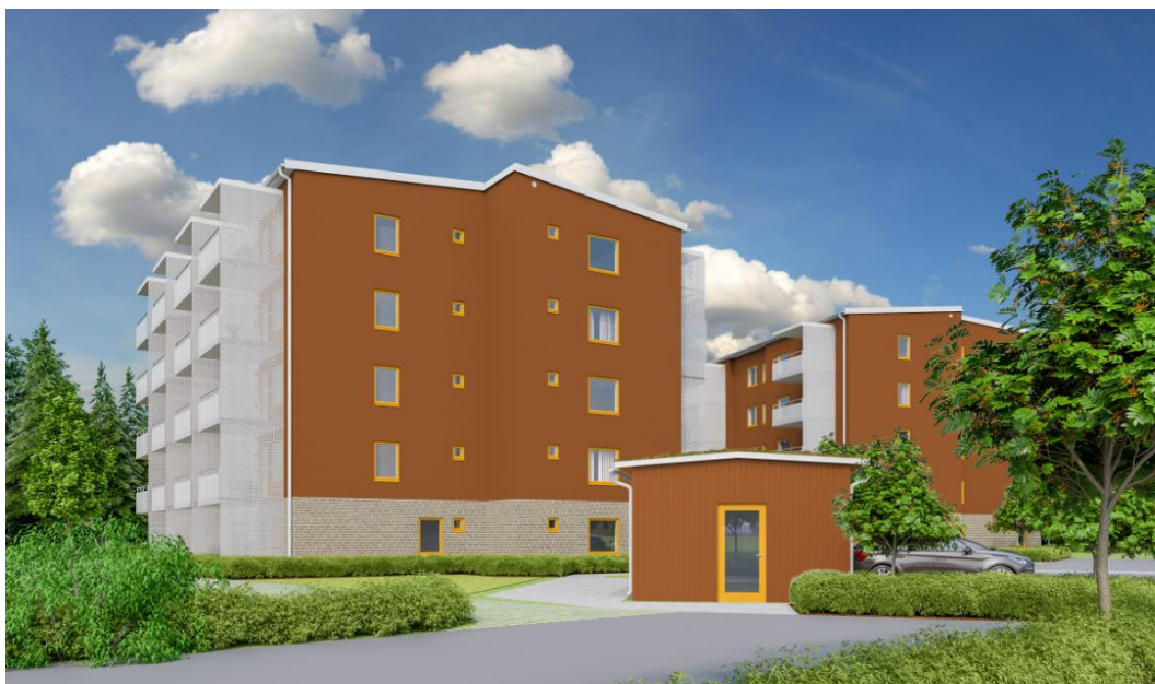
Figur 40 Vy från Björnskogsvägen, fasader i puts utan synliga elementfogar,
