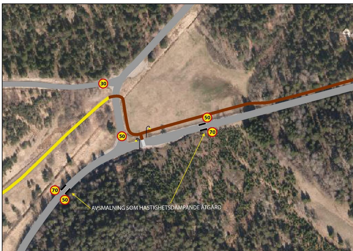
Figur 23. Illustration av hastighetssänkning, övergångsställe, avsmalning samt ny belysning.
