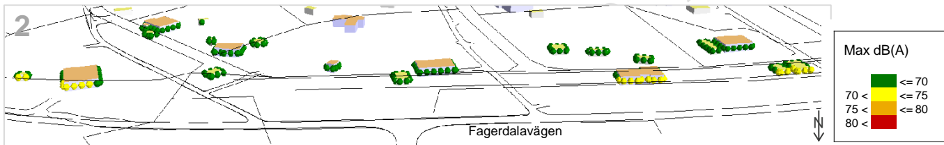
Figur 6.13 Maximala ljudnivåer vid fasad sett från norr (vid full omvandling till permanentbostäder).
