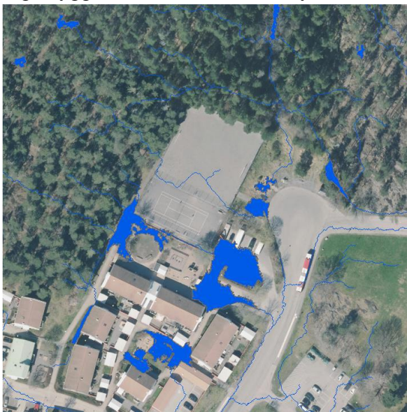
Figur 3. Skyfallskartering vid ett 100-årsregn, där 60 mm regn har applicerats på terrängmodellen (SCALGO Live, 2019). Kritiska punkter är inringade med svart.
